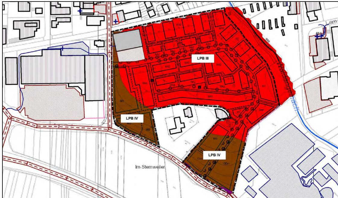
Lärmpegelbereiche Tagzeitraum. Aus: Ingenieurbüro für Bauphysik, 27.05.2021, Anlage 9.1
