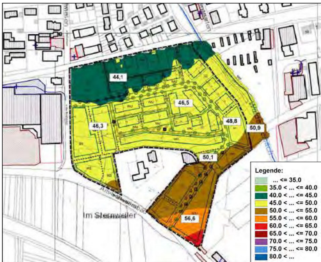
Ausschnitt aus der Pegelbeurteilungskarte Gewerbelärm Nacht (9 m über Gelände ohne Schallschutzmaßnahmen. Aus: Ingenieurbüro für Bauphysik, 27.05.2021, Anlage 6.2c
